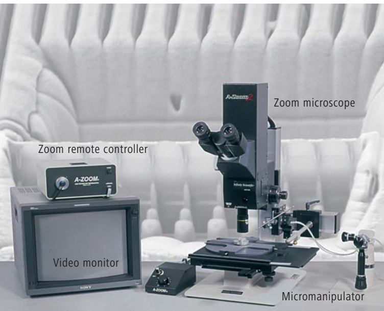
Fig. 1: TEM Lift-out Tool 1
