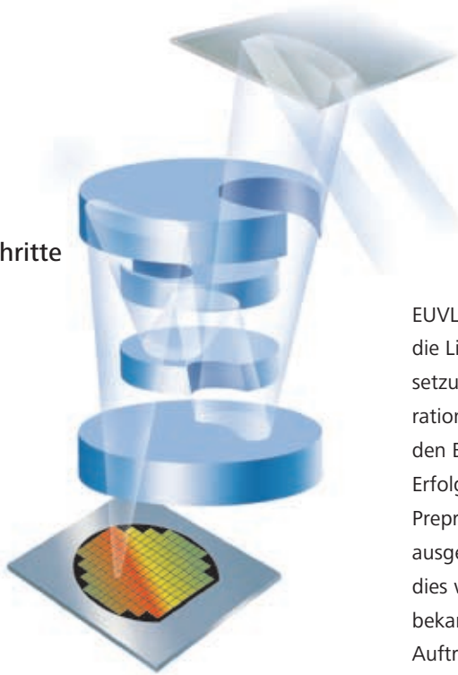
In dem komplexen Spiegelsystem der EUV PO-Box läuft das von der Maske reflektierte Licht im Zickzack hin und her, bevor es schließlich zur Abbildung gelangt.
